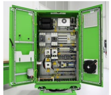
Speziell für die Schulungen auf die SENNEBOGEN Elektromaschinen steht ein neuer Elektroschaltkasten für das detaillierte Training zur Verfügung.
