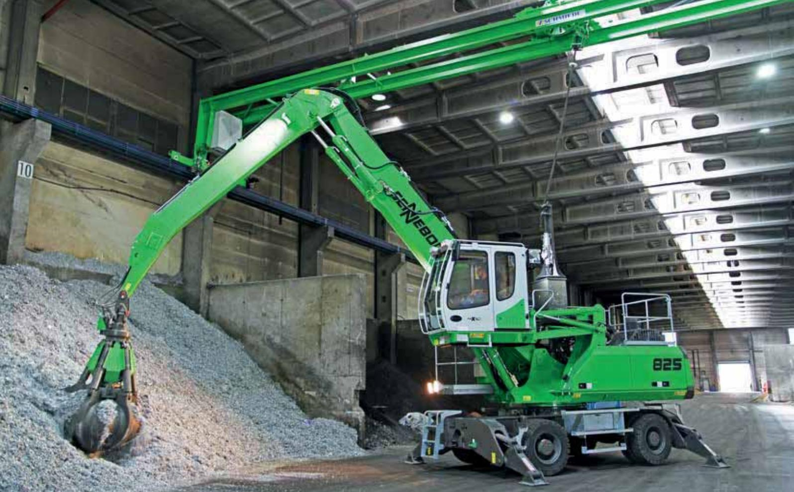
Deckenstromzuführung über mitfahrenden Brückenkran
