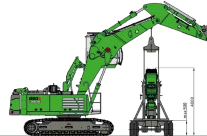
VERLADEOPTION DER 3-TEILIGEN ABBRUCH-AUSRÜSTUNG AB23 IM TRANSPORTGESTELL MIT HILFE DER 830 E DEMOLITION VARIO TOOL ERDBAUAUSTRÜSTUNG EA12
