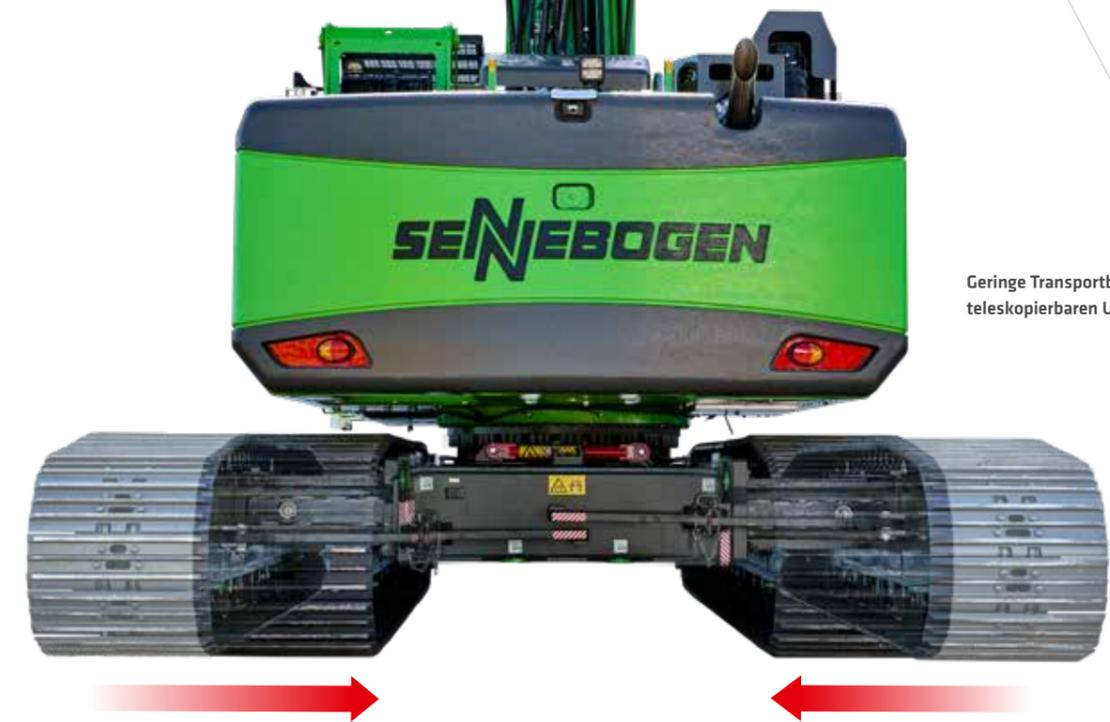
Geringe Transportbreiten durch teleskopierbaren Unterwagen
