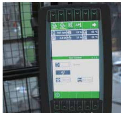
**Tool Control:** Die Mengen- und Druckeinstellung von bis zu zehn Werkzeugen erfolgt komfortabel aus der Kabine heraus.
