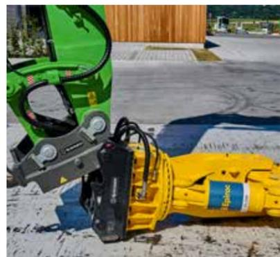
**Schnellwechsler:** Wechsel von Anbaugeräten in kürzester Zeit, z. B. wenn die Maschine flexibel bei der Sortierung und Verladung von Materialien wie Schutt, Kabeln oder Rohren benötigt wird.
