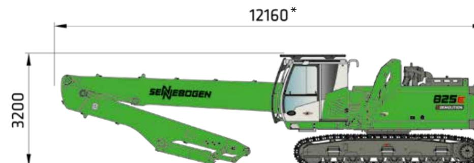
825 DEMOLITION MIT UNTERWAGEN T31/350 UND 2-TEILIGER AUSRÜSTUNG K14 ULM, HYDRAULISCH HOCHFABRBARER KABINE MAXCAB, 30° NEIGBAR UND VOLLHYDRAULISCH ABLEGBAREM KONTERGEWICHT (OPTION), EINSATZGEWICHT CA. 38 t
