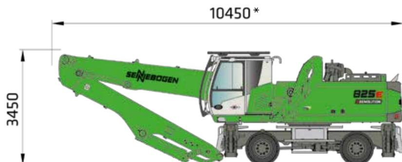
825 DEMOLITION MIT UNTERWAGEN MP26 UND AUSRÜSTUNG K12 ULM, HYDRAULISCH HOCHFABRBARE KABINE MAXCAB, 30° NEIGBAR, EINSATZGEWICHT CA. 29,5 t
