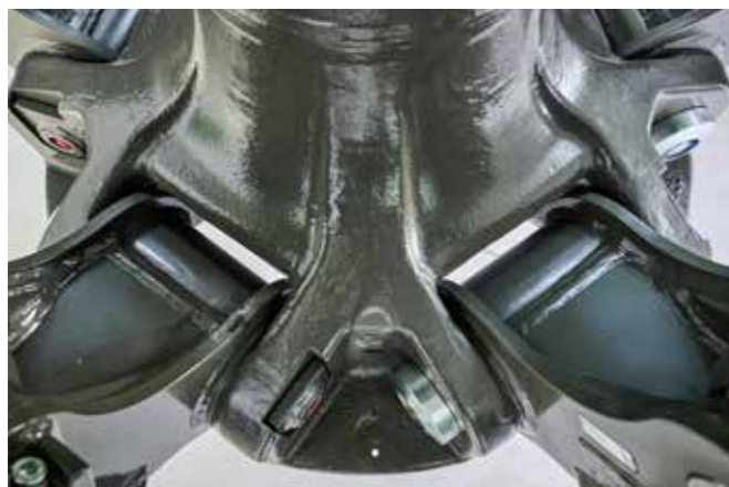
Öffnungen an den Schalendrehpunkten für wartungsarmen Betrieb
