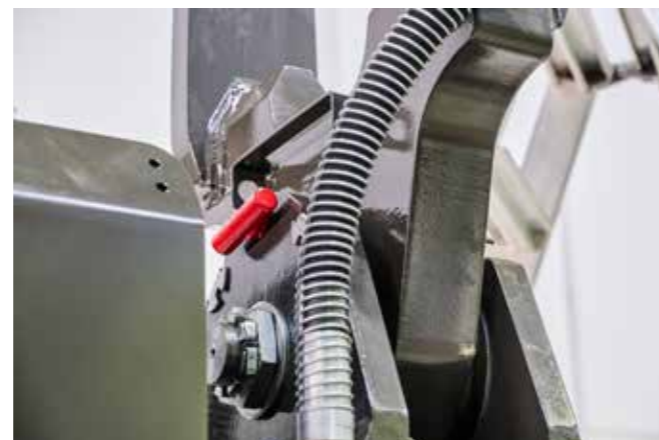
Bolzenabsteckung zur vertikalen Fixierung der Greiferaufnahme
