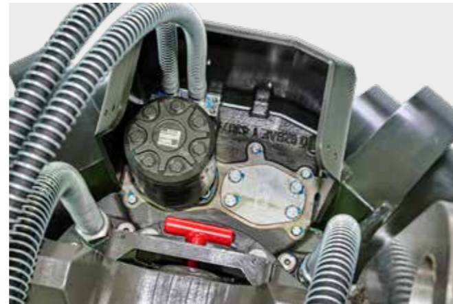
Geschützt montierter Drehmotor
