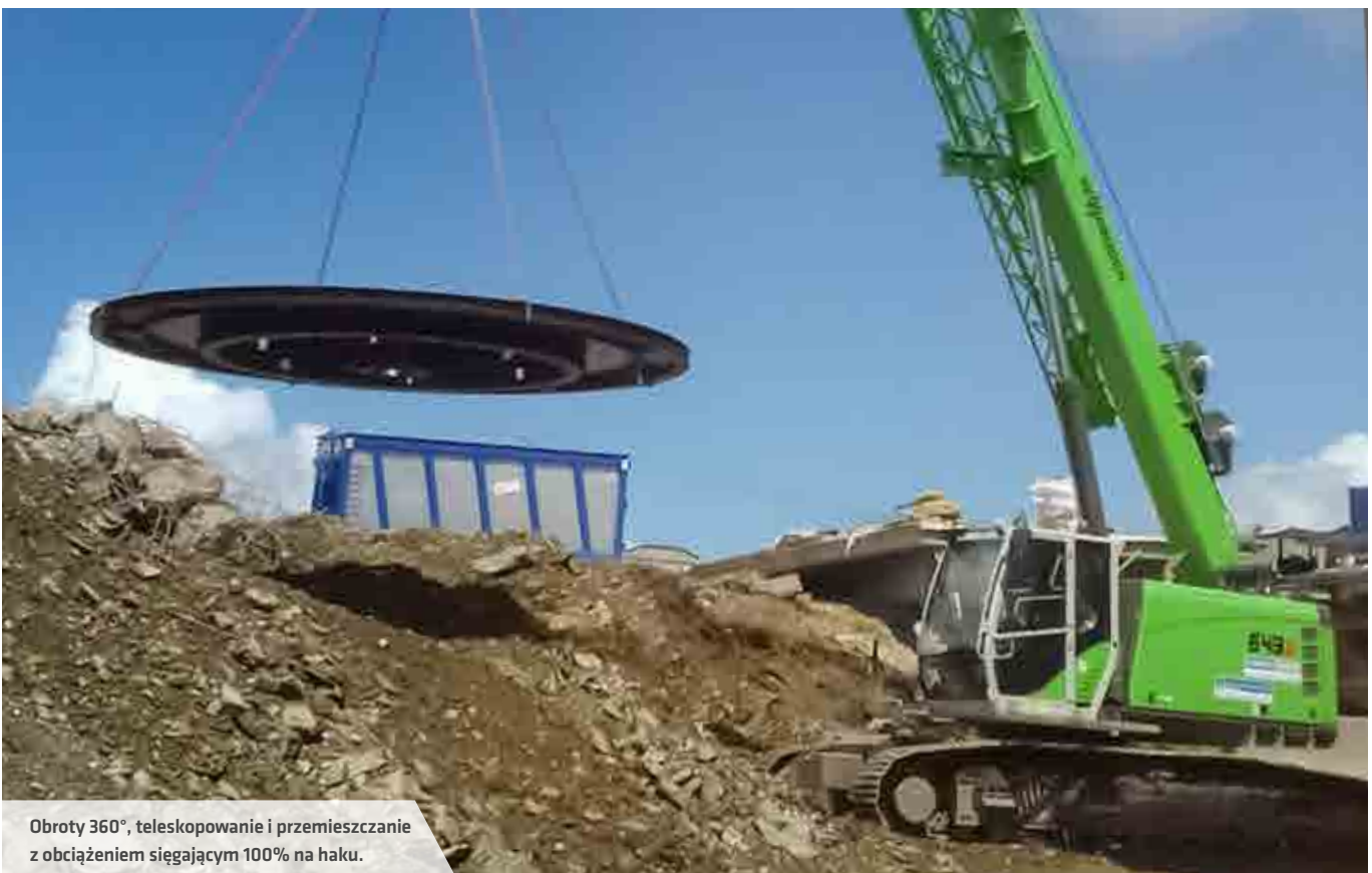
Doskonała sprawność jazdy terenowej; jazda na nierównym terenie i na wzniesieniach do 20°.
