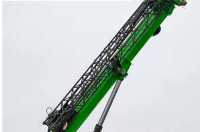
Wysięgnik pomocniczy z przedłużeniem, mocowany do wysięgnika głównego, gdy nie jest używany
