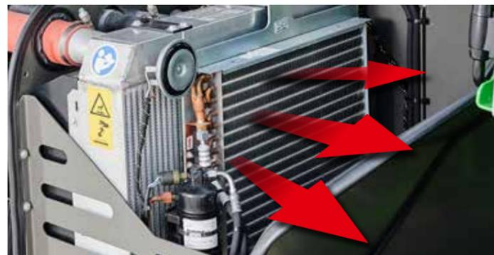
Der SENNEBOGEN 355 E arbeitet immer produktiv. Der serienmäßige und kräftige Umkehrlüfter sorgt zuverlässig für einen freien Lufteinlass und damit für die optimale Kühlleistung – auch unter schwersten Bedingungen.
