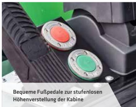
Bequeme Fußpedale zur stufenlosen Höhenverstellung der Kabine
