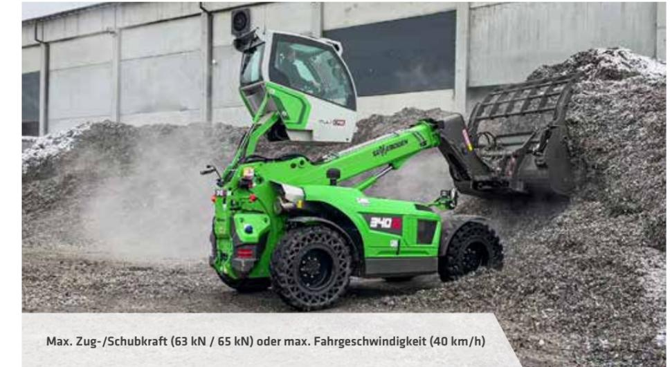
Max. Zug-/Schubkraft (63 kN / 65 kN) oder max. Fahrgeschwindigkeit (40 km/h)
