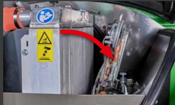
2 Sehr gute Zugänglichkeit zum Kühler, durch klappbaren Verflüssiger der Klimaanlage.
