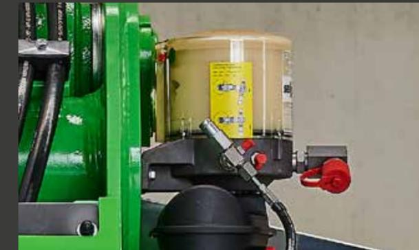
5 Die zentrale Schmieranlage garantiert eine verlängerte Lebensdauer der Maschine durch kontinuierliche und automatisierte Schmierzyklen.
