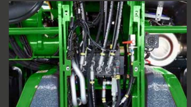
6 Bestmöglicher Zugang zum Hauptsteuerblock.
