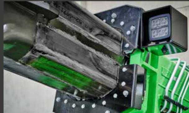
3 Gleitführungen des Teleskopauslegers sind von außen zugänglich – einfache Wartung und lange Lebensdauer.
