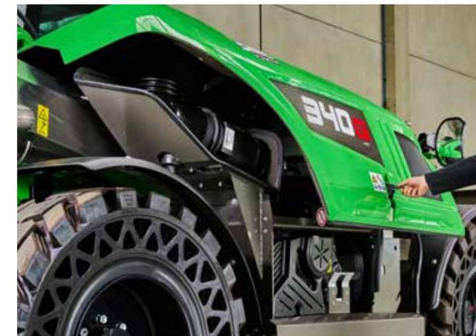
Mit einem Handgriff geräumiger Zugang zum Motorraum. Das Seitenblech der Motorgondel ist zusätzlich abnehmbar.
