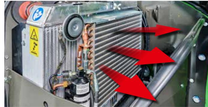
Der SENNEBOGEN 340 G arbeitet immer produktiv. Der serienmäßige und kräftige Umkehrlüfter sorgt zuverlässig für einen freien Lufteinlass und damit für die optimale Kühlleistung – auch unter schwersten Bedingungen.
