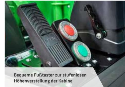
Bequeme Fußtaster zur stufenlosen Höhenverstellung der Kabine
