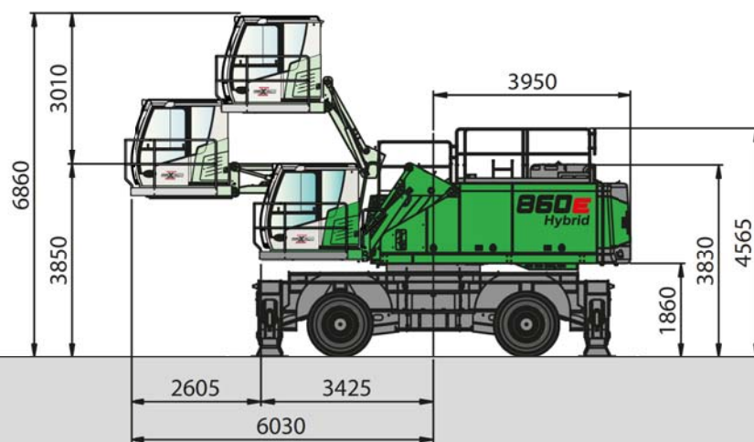
860 M mit Unterwagen MP71 und hydraulisch hoch- und vorfahrbarer Kabine maXcab E300/260
