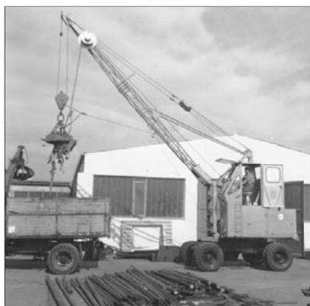
1962: Seilbetriebener S833 mit erhöhter Fahrerkabine
