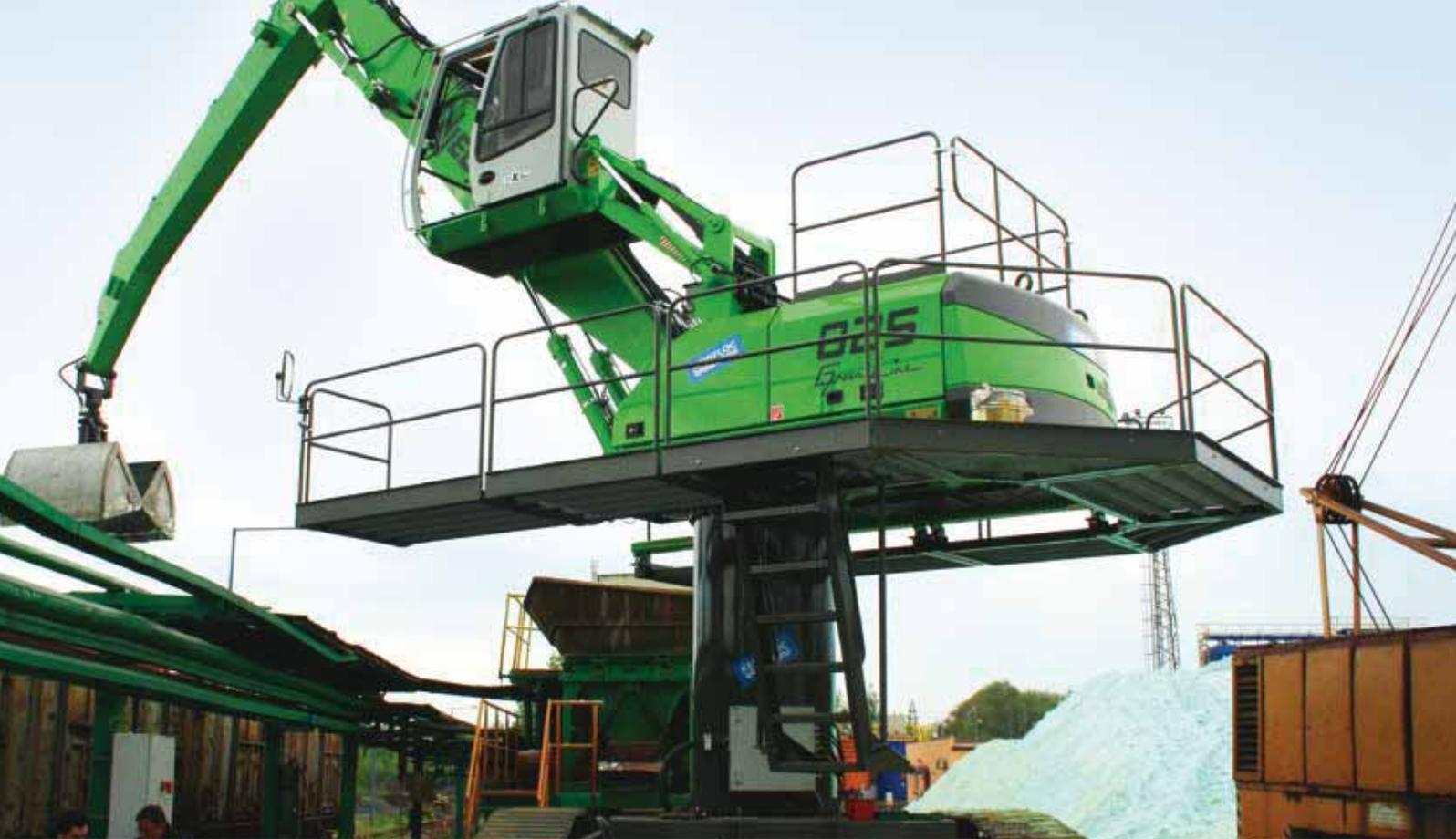
825 R – sicheres Arbeiten in der Höhe dank Geländer am Oberwagen
