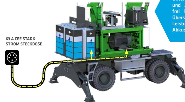
Starkstromanschluss am Unterwagen. Oberwagen und Ausrüstung können frei beweglich arbeiten. Überschüssig eingespeiste Leistung lädt zugleich die Akkus nach.
