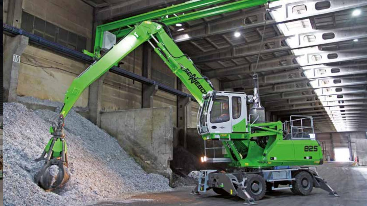
825 M Elektro - Schrottschlag in der Halle mit Deckenstromversorgung; Deutschland
