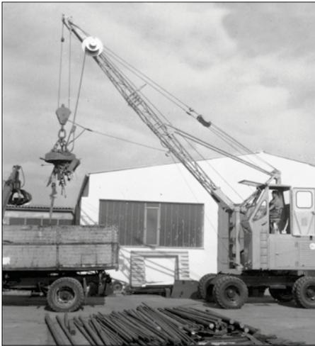
1962: Seilbetriebener S833 mit erhöhter Fahrerkabine
