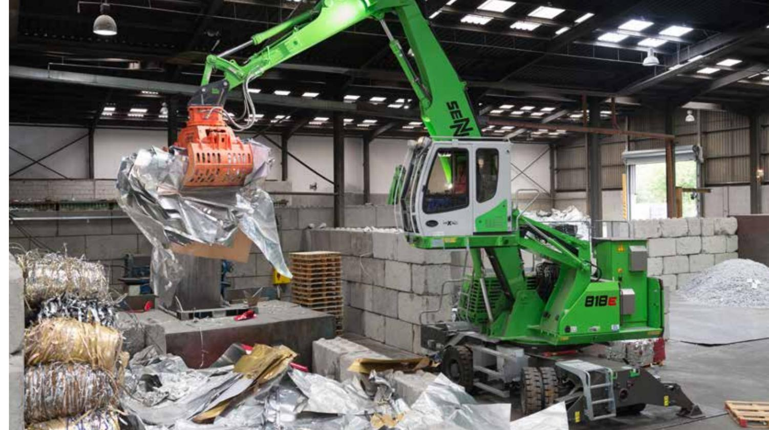
818 M Elektro - Beschickung einer Ballenpresse mit Sortiergreifer
