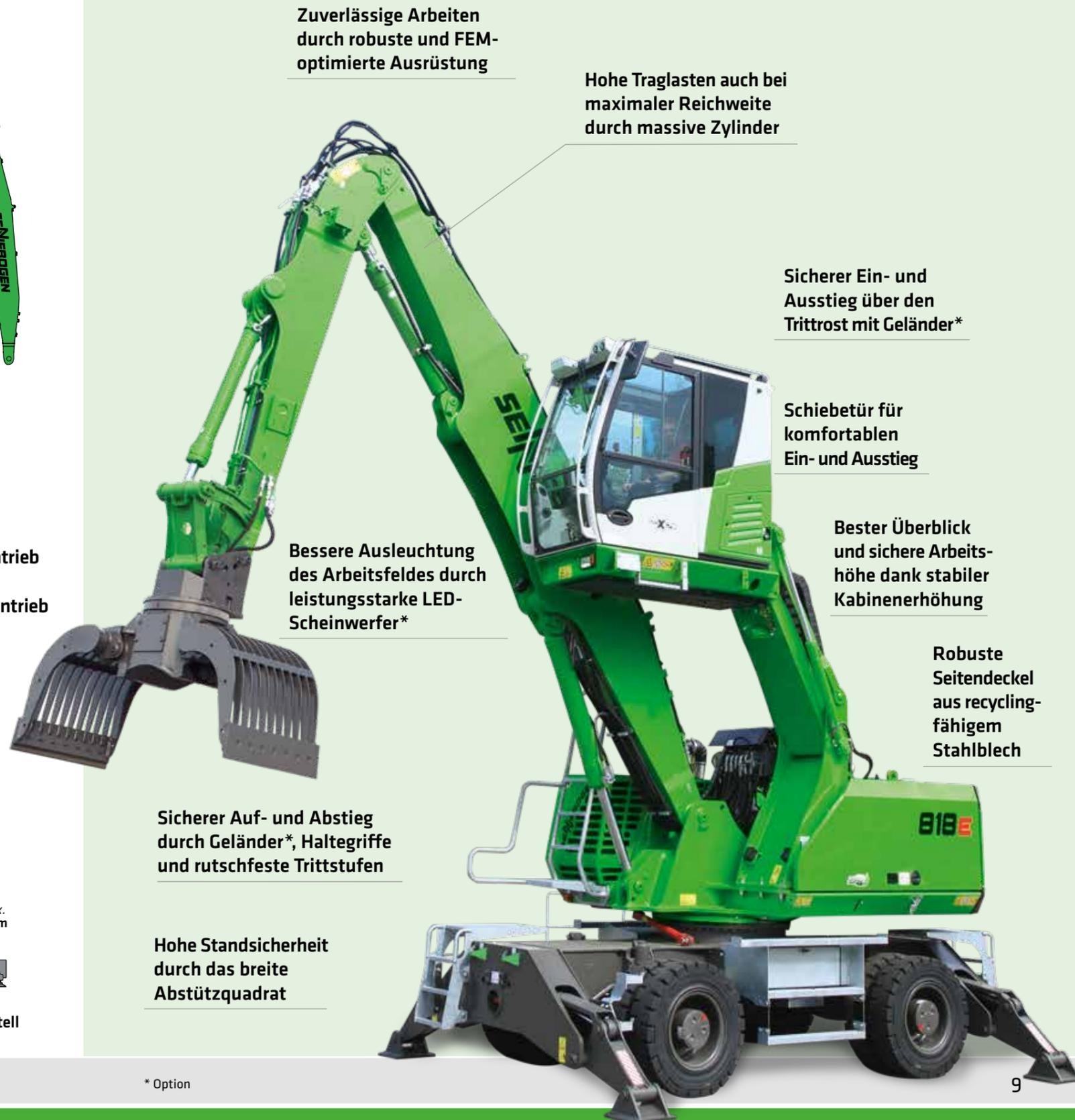
Zuverlässige Arbeiten durch robuste und FEM-optimierte Ausrüstung
