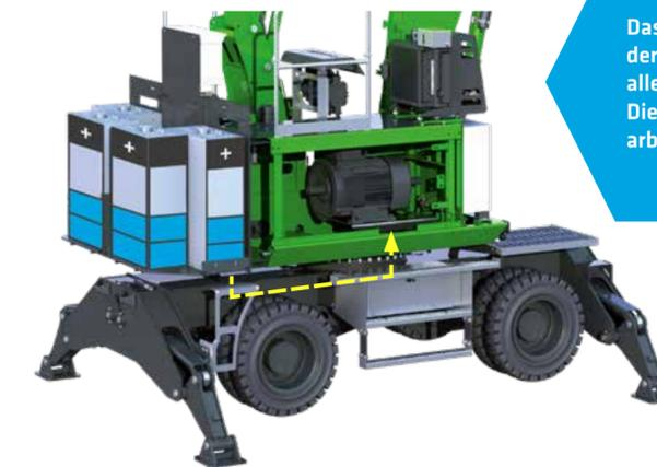
Das Akku-Pack im Heck der Maschine fungiert als alleinige Energiequelle. Die Maschine fährt und arbeitet komplett autark.
