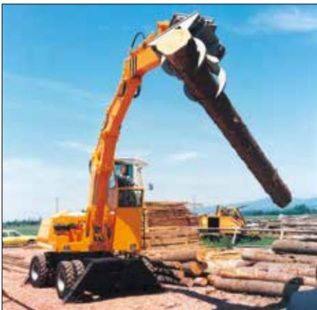
1974: Holz-Umschlagmaschine mit erhöhter Fahrerkabine
